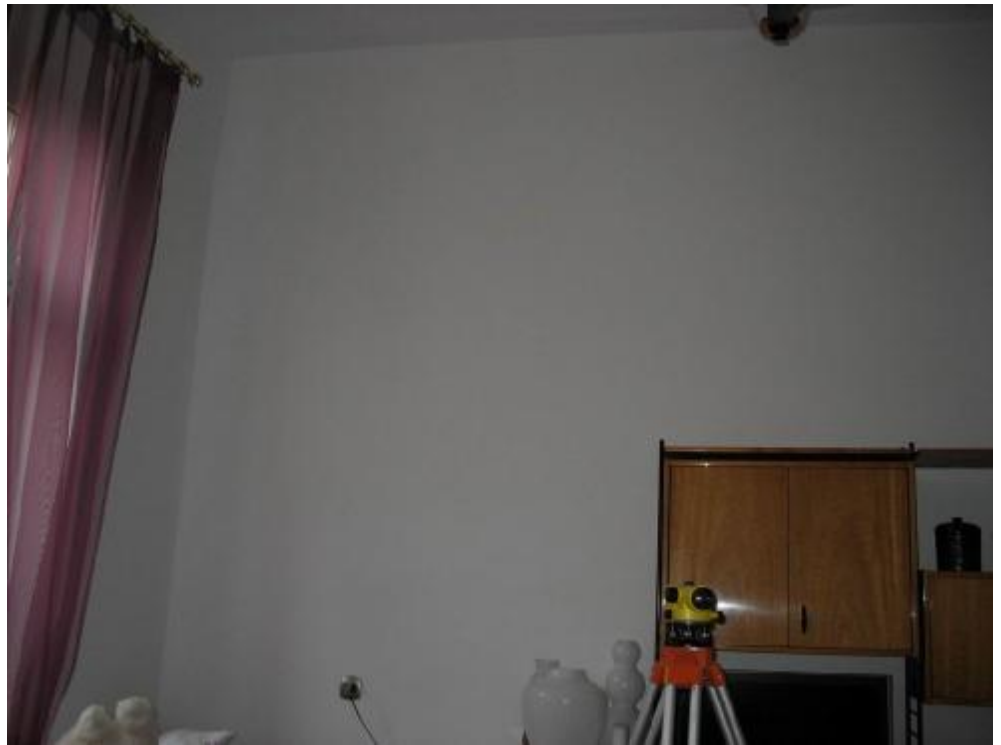
Fot.27 Pomiar ugięć stropu niwelatorem Leica
